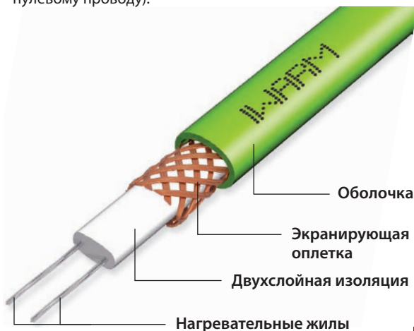
Конструкция нагревательного кабеля
