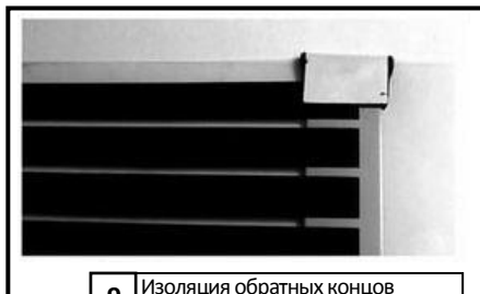
9 Изоляция обратных концов медных проводников
