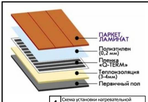
4 Схема установки нагревательной пленки под ламинат/паркет
