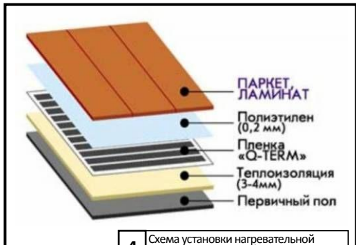
4 Схема установки нагревательной пленки под ламинат/паркет
